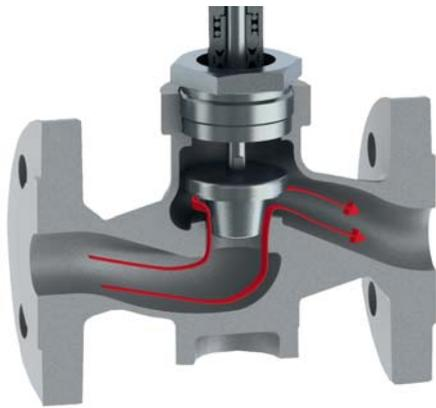
Pour influencer avec souplesse le débit volumétrique dans une tuyauterie, une simple commande Ouvert/Fermé ne suffit pas. Le débit volumétrique doit être réglé avec précision à l'intérieur d'une plage adaptée aux tâches de régulation. Les vannes sont équipées à cet effet de limiteurs de débit. Ces vannes peuvent être conçues et fabriquées selon l'application afin d'obtenir les caractéristiques de régulation souhaitées.
